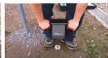
④最大限まで押し込んだら、STOPをタップすれば測定は終了です。ここで、補正するかどうかが表示されますが、はキャンセルしてください。
