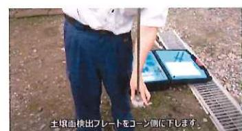
②土壤硬度計本体を両手でしっかりと持ち、両足の間に挟み込むようにして、土壤表面に垂直にコーンを押し込みます。
