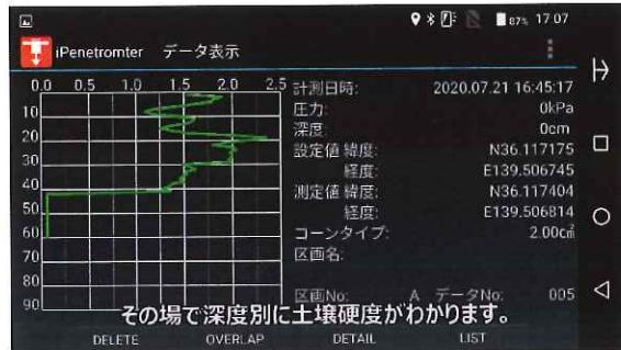
・過去の測定データを表示したいときは、操作メニューの「データ表示」で「LIST」を選択し、表示したいデータを選択してください。
