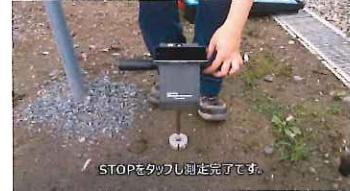
⑤測定後は、その場で土壤硬度がわかりますので、測定されているか確認してください。
